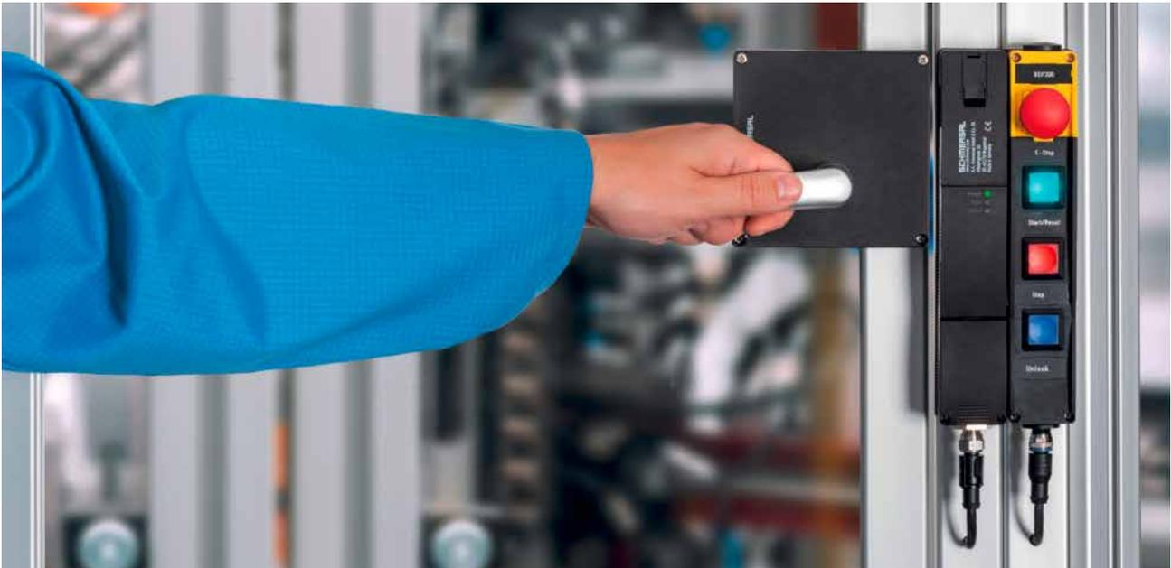
Der Sicherheitsschalter AZM201D mit doppelter Sicherheitsfunktion wird häufig für den Einrichtbetrieb in Roboteranlagen eingesetzt.
