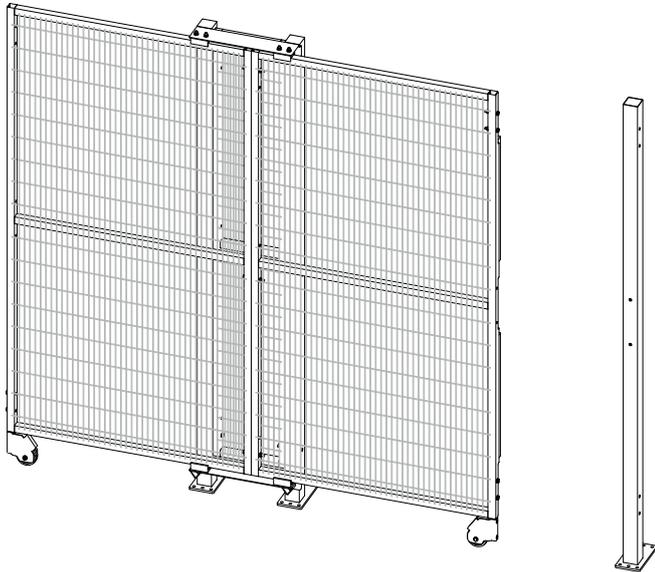
Porte coulissante sans rail pour laisser le passage libre. L'ouverture est créée par un système de patins de glissement fixés à une structure constituée de deux montants alignés et de roulettes au sol.
