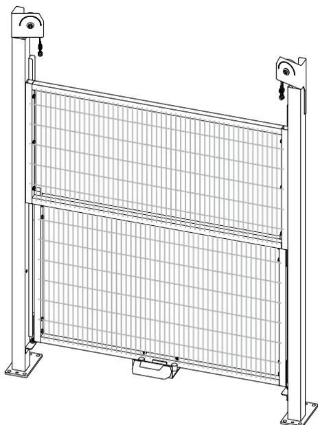
Porte équipée d'un contrepoids pour régler le mouvement d'ouverture et de fermeture. Le nombre réduit de composants rend l'assemblage simple et rapide.
