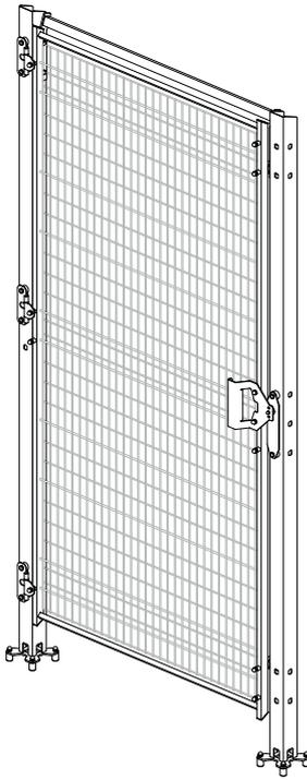
Porte pour le passage humain avec charnières, équipée d'un panneau grillagé à cadre plat soudé, de fils de 4 et 6 mm, d'une traverse supérieure de 20 x 30 mm et d'une serrure magnétique.
