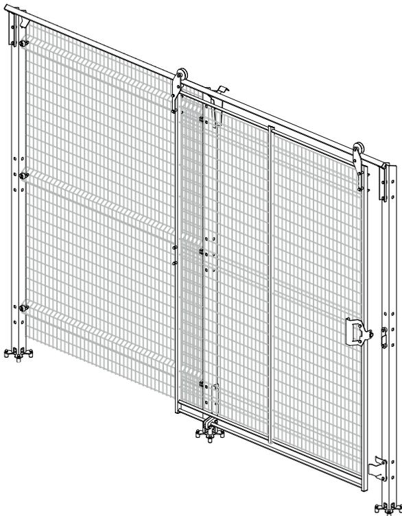
Porte coulissante avec Guide supérieur ouvert, équipée d'un panneau grillagé à cadre plat soudé, de fils de 4 et 6 mm, d'une traverse supérieure de 20 x 30 mm et d'une serrure magnétique.
