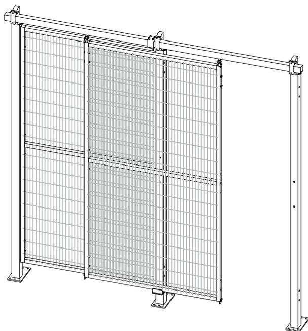
Porte coulissante suspendue par un guide supérieur pour permettre le passage des charges volumineuses au sol. La partie inférieure de la porte est guidée par un patin de glissement.
